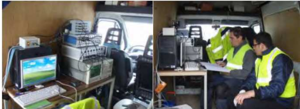
Véhicule laboratoire: ordinateur et carte de numérisation pour l'enregistrement des données, alimentation des capteurs, filtrage analogique et analyseur de spectre temps réel
