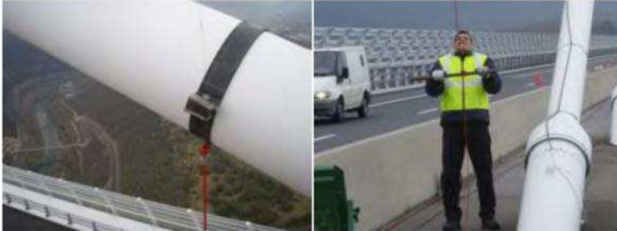
Collier pour l'excitation (photo de gauche) et excitation manuelle des premiers modes (photo de droite)
