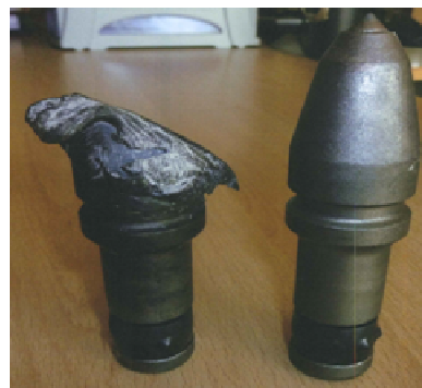
Figure 18 : Effet du béton présent dans le sol sur les outils de forage (présentation PPT d'Alexandra COUTAUD JOLY)
