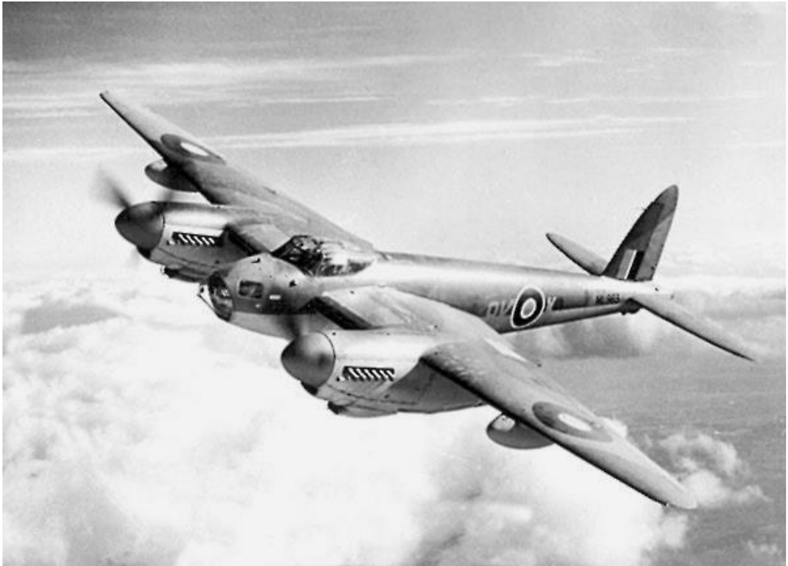
Mosquito (1944) réalisé en bois moulé (bouleau, balsa, bouleau) http://en.wikipedia.org/wiki/Plywood
