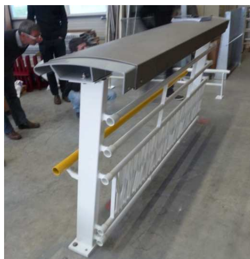
Figure 21 : Prototype de garde-corps sur belvédère
