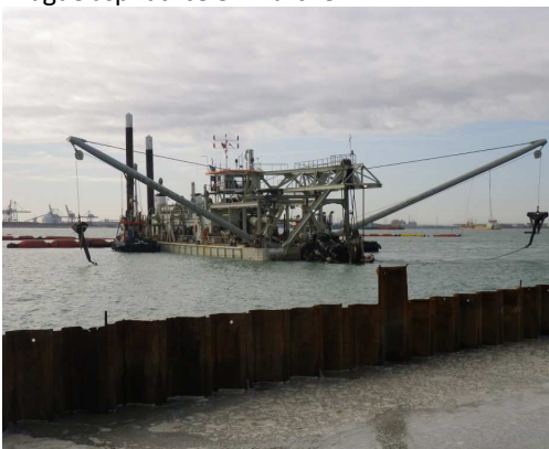
Drague stationnaire - Rendement 110 000 m 3 /sem
