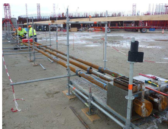
Maquettes d'injections horizontales à l'échelle 1 (longueur 24 m)
