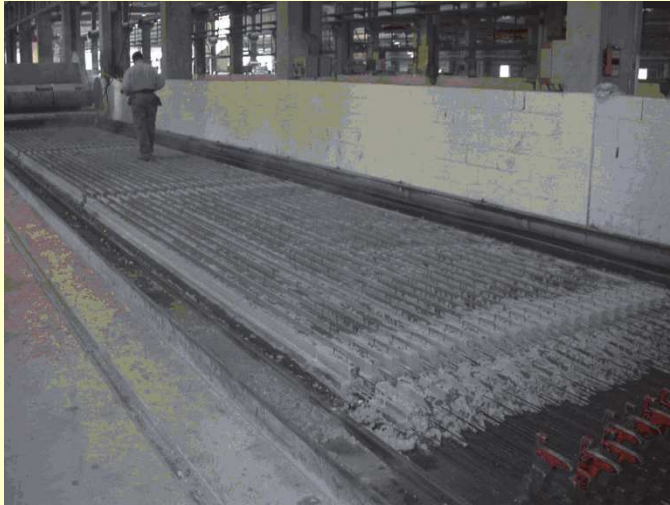
Banc de préfabrication
