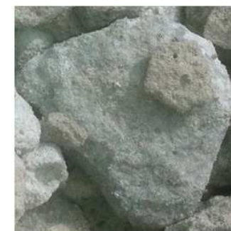
Laitier AOD stabilisé 4/22,4 (couleur vert clair) d'oxydes
