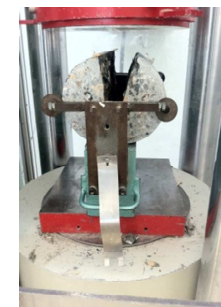
Essai de traction par fendage
