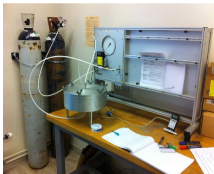
Mesure de la perméabilité
