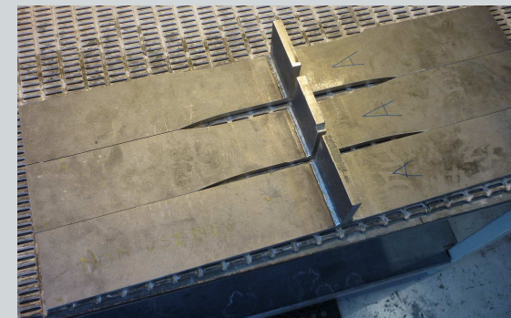
Acier S355 J2 – « T Assemblage en T ».
