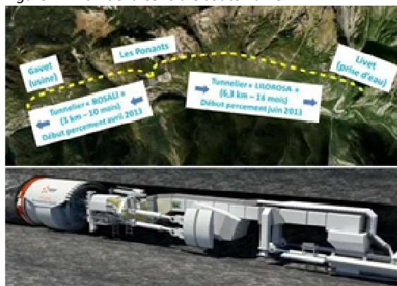
Figure 8 : Le chemin des tunneliers et le tunnelier
