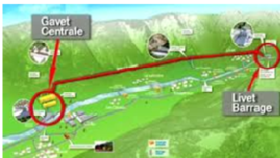
Figure 4 : Tunnel entre la centrale et le barrage (9,3 km, diamètre de 4,7 m)
