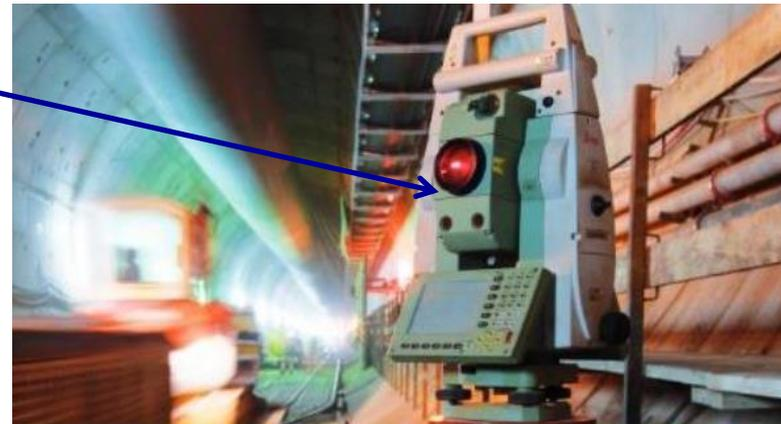
Les relevés en X,Y et Z sont transmis à un ordinateur (**paramètres topographiques** de la cabine de guidage) qui identifiera en temps réel les écarts entre la position théorique programmée et la position réelle.
