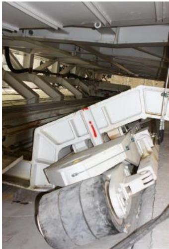
Les 3 remorques roulent sur des roues en polyuréthane (diamètre 0.35m).
