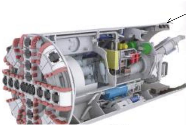
**-Joints DE QUEUE** souples et renouvelable: brosses métalliques entre les lesquelles est injectée en permanence une graisse épaisse spéciale.
