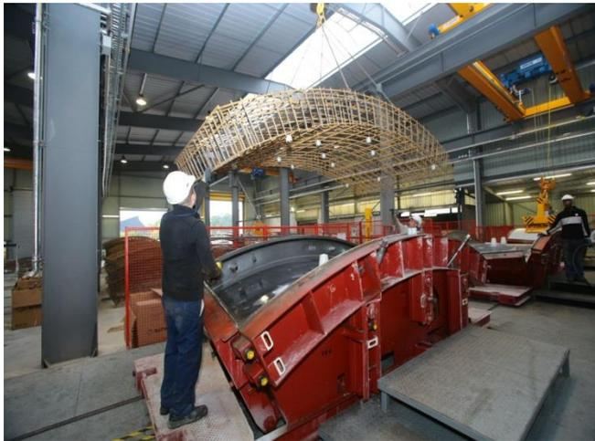
Fabriquer dans moules spécifiques; ils sont en béton armé ou en béton avec de la fibre métallique.
