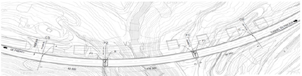
Implantation des appuis du nouvel ouvrage
