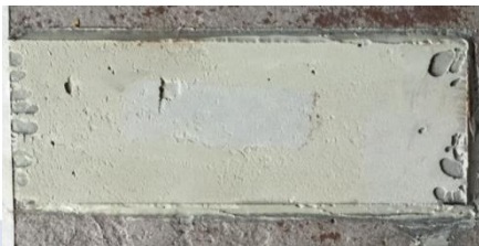
Mode de rupture procédé A
