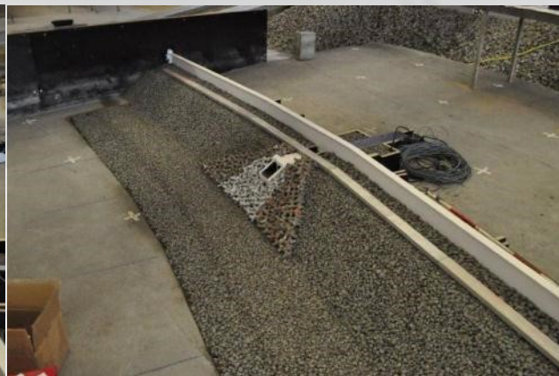
Mise en place des blocs autour de l'OH
