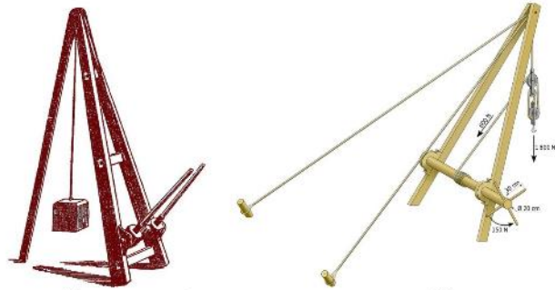
Figure 3 : Chèvres (a) tripode (b) à haubans avec palan, source [2]
