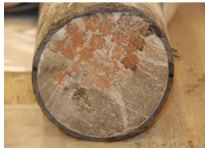
Section d'une gaine PEHD injectée au coulis de ciment
