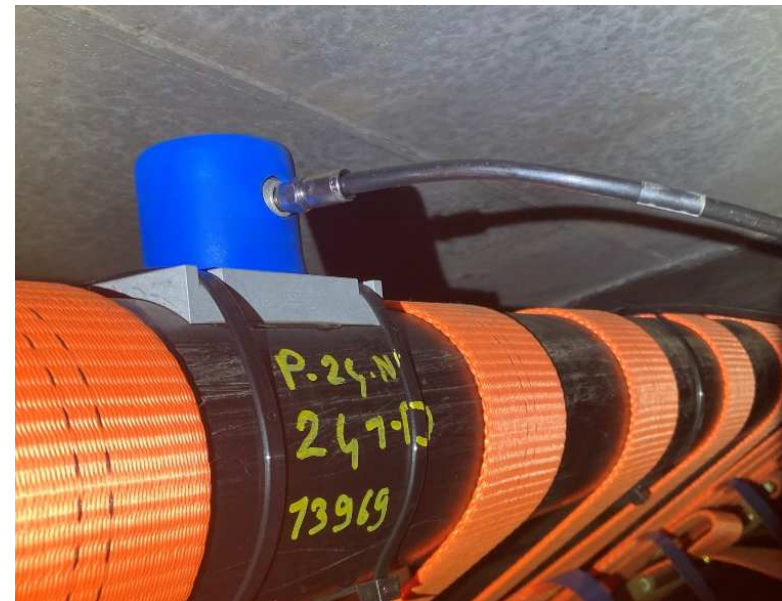
Capteur câble: surveillance dans leur partie courante
